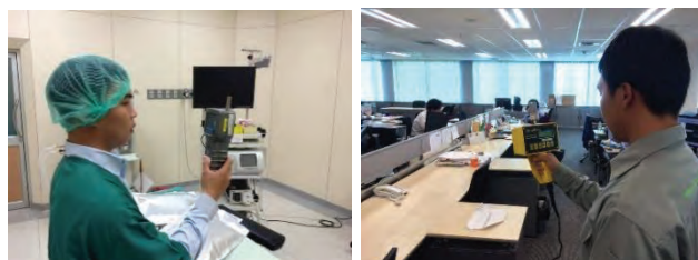
รูปที่ 97 การใช้เครื่องตรวจวัดคุณภาพอากาศในอาคาร
